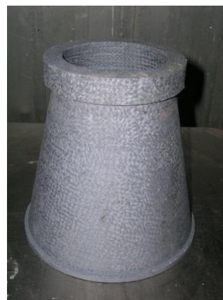
Сопло реактивного двигателя с нанесенным покрытием из карбидокремния
