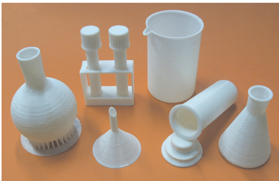
Рис. 1. Примеры лабораторного оборудования, созданного методом FDM 3D-печати из PLA и используемого в повседневной практике: коническая колба, круглая колба, воронка, пробирки, химический стакан.
