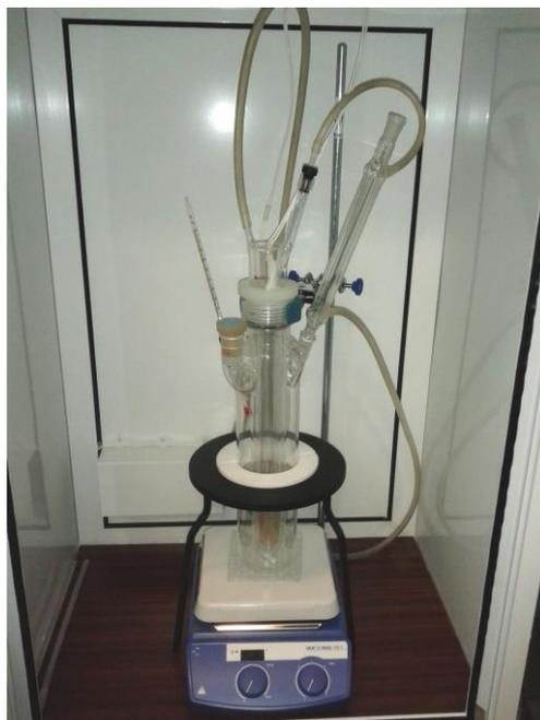
**Рис. 12.** Фотореактор "Ace photochemical reaction assembly"
