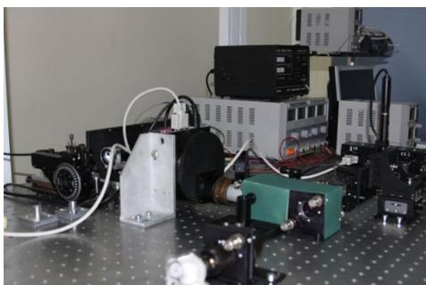
**Рис. 3.** Фото прототипа оптического устройства двухфотонной записи и считывания оптической информации с мультислойных трёхмерных оптических дисков.
