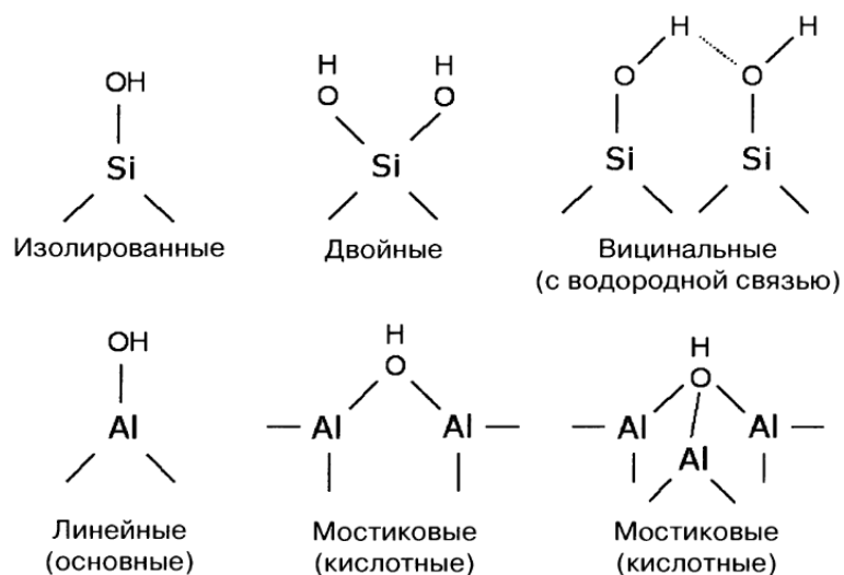
Рисунок 4. Примеры гидроксильных групп, присутствующих на поверхности силикагеля и оксида алюминия [127].
