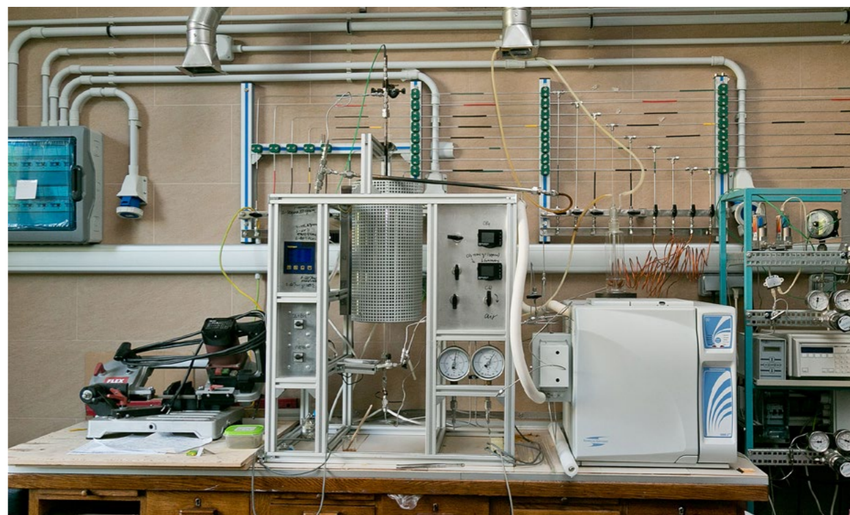
▲ Проточная каталитическая установка конверсии \text{CO}_2 (оснащение комнаты произведено на средства гранта РФФ)
