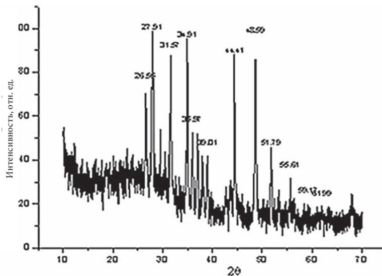
Рис. 5. Спектр XRD образца  $Pd_{17}Se_{15}$ , полученного при термолизе  $Pd(SeC_b^0Ph)_2(PEt_3)_2$  в гексадецилаmine при 330 °С.
