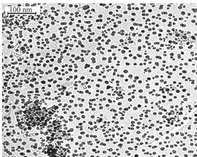
Рис. 1. Микроструктура и морфология продукта термолитза (T = 773 К) акриламидного комплекса Co(II) по данным просвечивающей электронной микроскопии.
