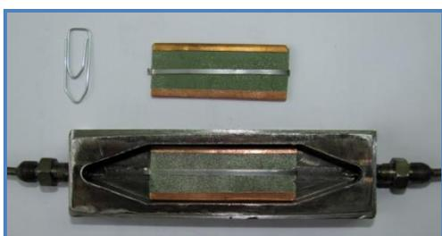
Микрореактор и МК пластина с нанесённым катализатором Cu/ZrO<sub>2</sub>.
