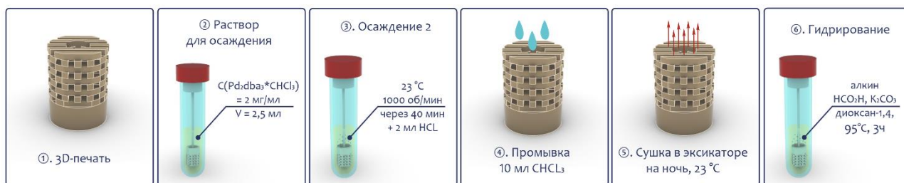
Рисунок 5. Схема процесса иммобилизации активного палладия(0) на трёхмерную полимерную структуру, изготовленную методом 3D-печати, в ходе кислотно-индуцированного осаждения для создания каталитических 3D-картриджей.
