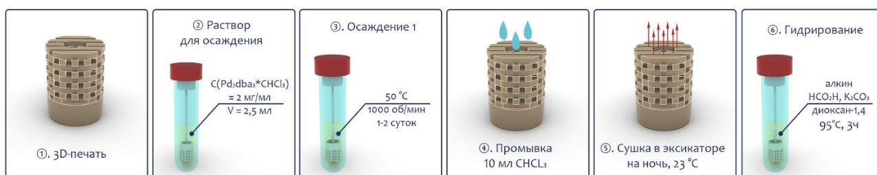
Рисунок 4. Схема процесса иммобилизации активного палладия(0) на трёхмерную полимерную структуру, изготовленную методом 3D-печати, в ходе термически инициированного разложения комплекса \text{Pd}_2(\text{dba})_3 \cdot \text{CHCl}_3 для создания каталитических 3D-картриджей.
