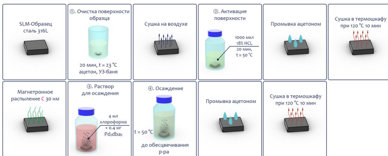
Рисунок 9. Осаждение наночастиц палладия на поверхность SLM-подложки из нержавеющей стали 316L: нанесение углеродного слоя толщиной 30 нм методом магнетронного распыления и последующая иммобилизация палладия путём термического разложения прекурсора \text{Pd}_2(\text{dba})_3 в хлороформе.
