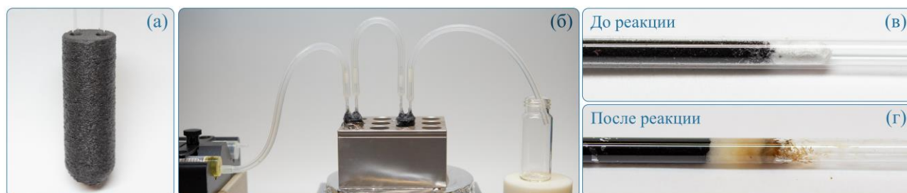
Рисунок 2. (а) Фотография проточного реактора, изготовленного из РА6-CF методом FFF с двумя стеклянными капиллярами; (б) полностью собранная система, состоящая из шприцевого насоса, двух взаимосвязанных проточных реакторов внутри металлического нагревательного блока и приемника продукта реакции, (в) каталитическая трубка до реакции, (г) каталитическая трубка после реакции.
