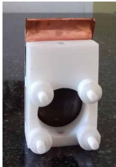
Рисунок 4. Конструкция электролизера из ПТФЭ. Стенка анода удалена для демонстрации катода из медной фольги, покрытого электроосажденными наночастицами германия
