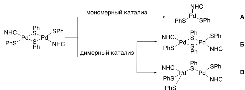
Схема 6. Возможный механизм образования активных частиц из димерного комплекса ((\text{NHC})\text{Pd}(\text{SPh})_2)_2 .
