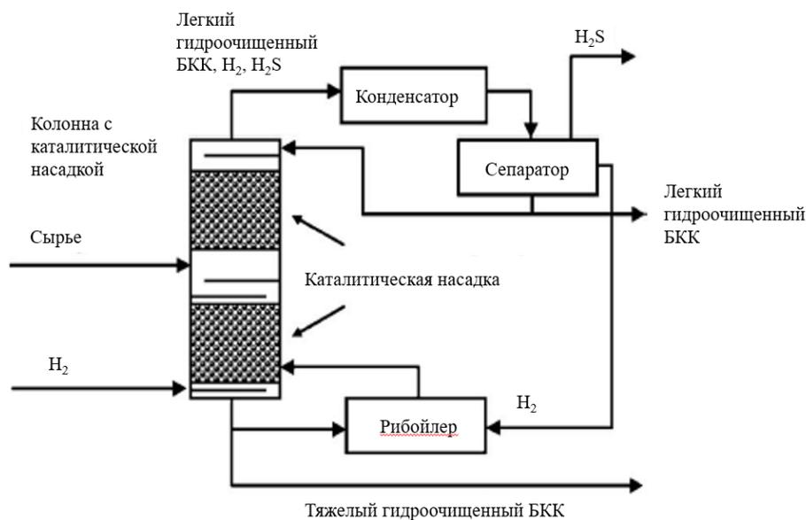
Рисунок 1.5 – Принципиальная схема процесса CDHDS (CDTECH)
