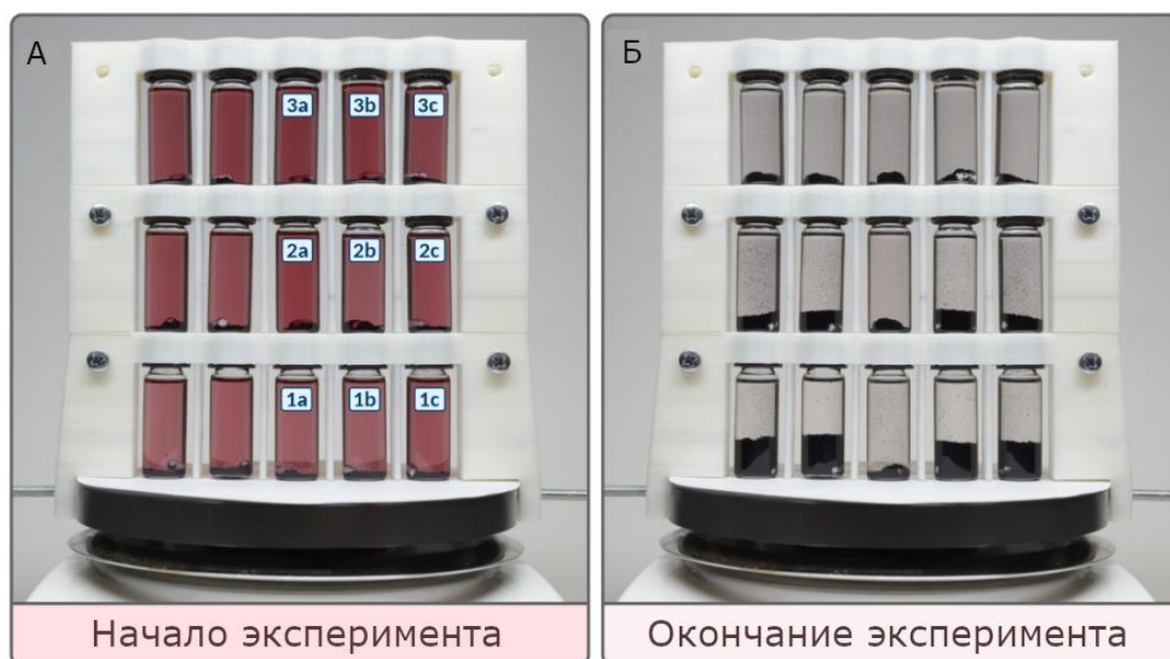
Рисунок 13. Вариации в параллельных реакциях. Фотографии установки для синтеза Pd/C в начале (а) и в конце (б) эксперимента.
