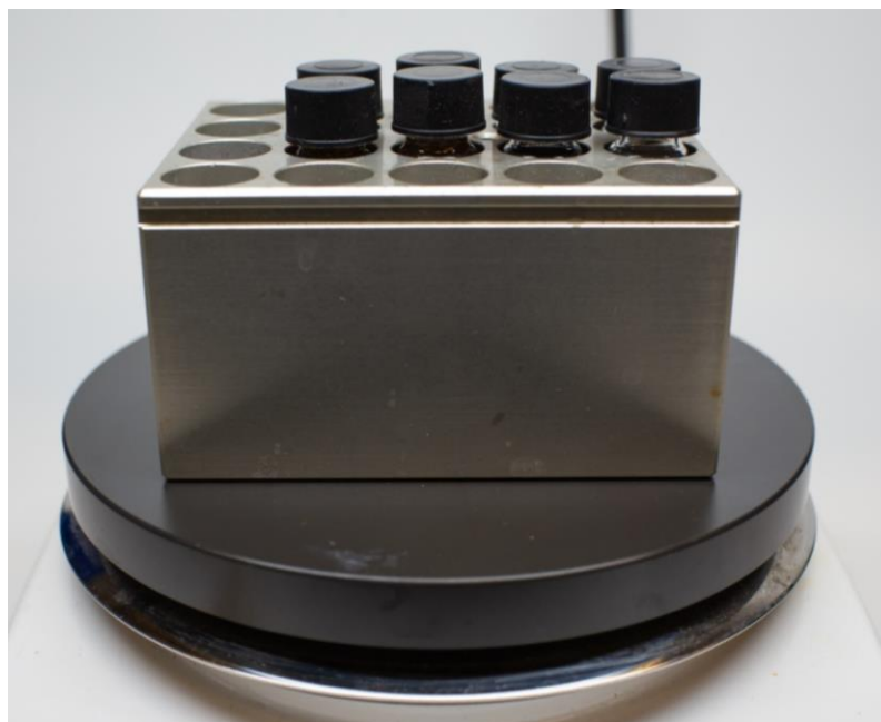
Рисунок 8. Проведение нескольких реакций одновременно с использованием виал в термоблоке.
