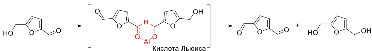
Схема 16. Схема МПВО реакции с ГМФ.
