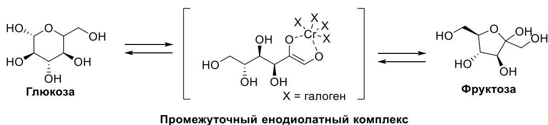
Схема 2. Предполагаемый механизм катализируемой хромом трансформации глюкозы в фруктозу.
