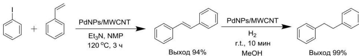
**Схема 1.23.**  $\text{PdNPs/MWCNT}$  как катализатор в реакции Хека и гидрирования.
