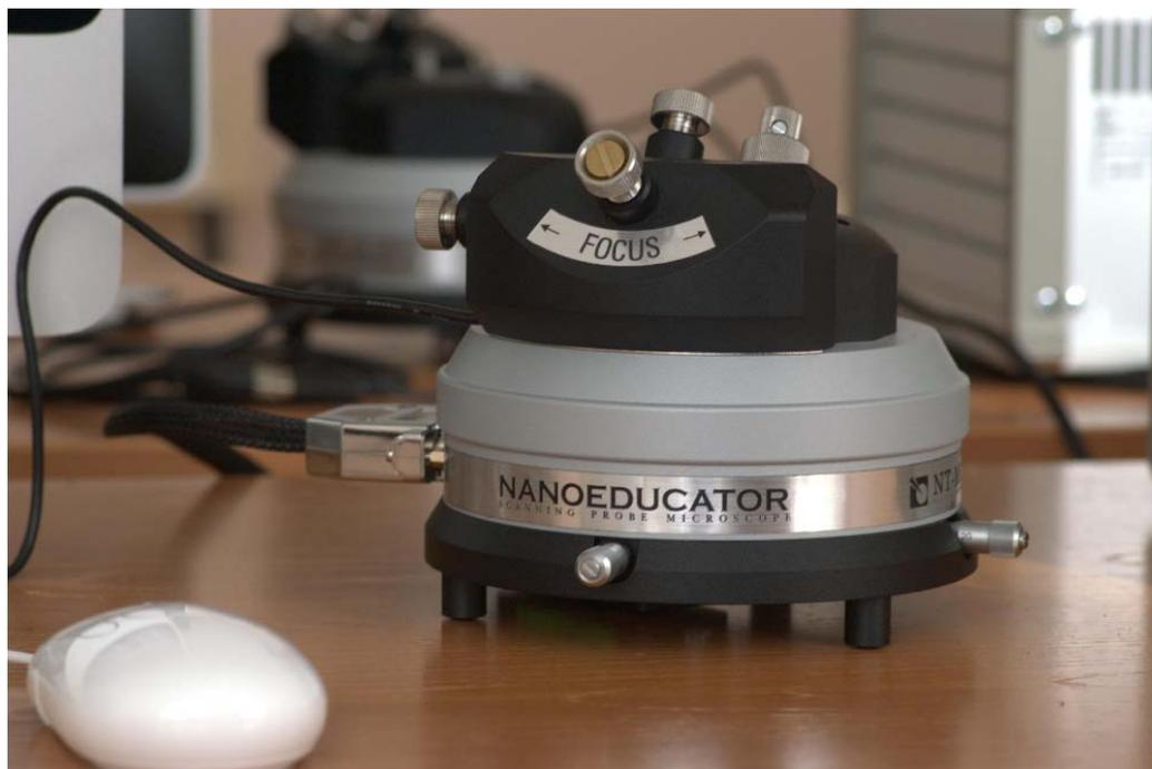
**Рис. 18.** Силовой зондовый микроскоп NanoEducator
