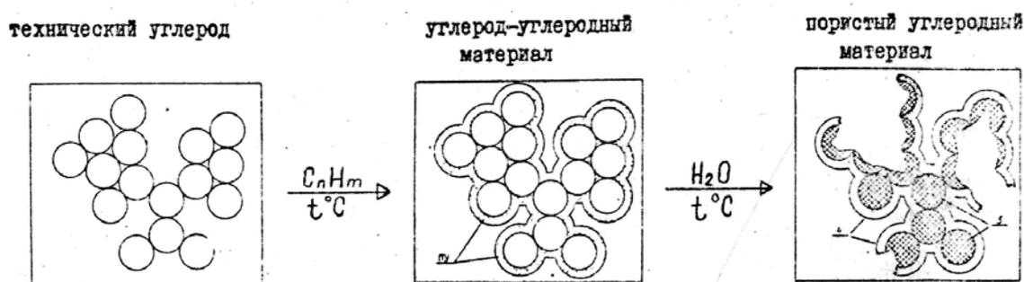
Рис. 7 Модель формирования пористой структуры материалов типа сибунита.
