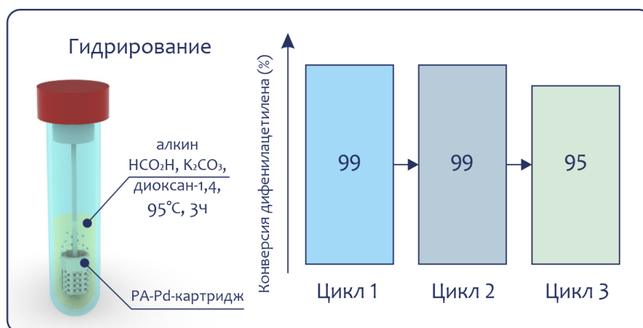
Рисунок 32. Степень превращения дифенилацетилена при использовании одного и того же Pd-картриджа из полиамида (РА) в трёх последовательных каталитических циклах.
