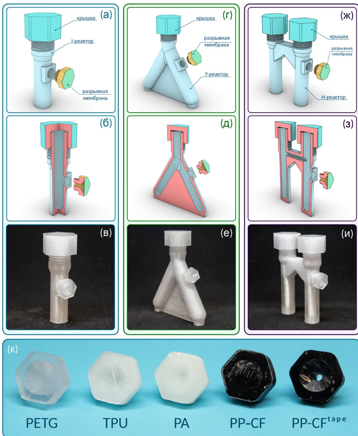
Рисунок 22. Предохранительный модуль с разрывной мембраной, интегрированный в специально выбранное место реактора: (а, г, ж) – 3D-модели I-реактора типа 1, Y-реактора типа 1 и H-реактора типа 1 с крышкой и боковым предохранительным модулем, оснащённым разрывной мембраной; (б, д, з) – разрезы I-реактора типа 1, Y-реактора типа 1 и H-реактора типа 1 с крышкой и боковым предохранительным модулем с разрывной мембраной; (в, е, и) – готовые к использованию I-реактор типа 1, Y-реактор типа 1 и H-реактор типа 1 с крышкой и боковым предохранительным модулем с разрывной мембраной, изготовленные из PETG; (к) – предохранительные модули с разрывной мембраной, изготовленные из PETG, TPU, PA и PP-CF (в модуле PP-CF-tape разрывная мембрана выполнена из прозрачной полипропиленовой клейкой ленты).
