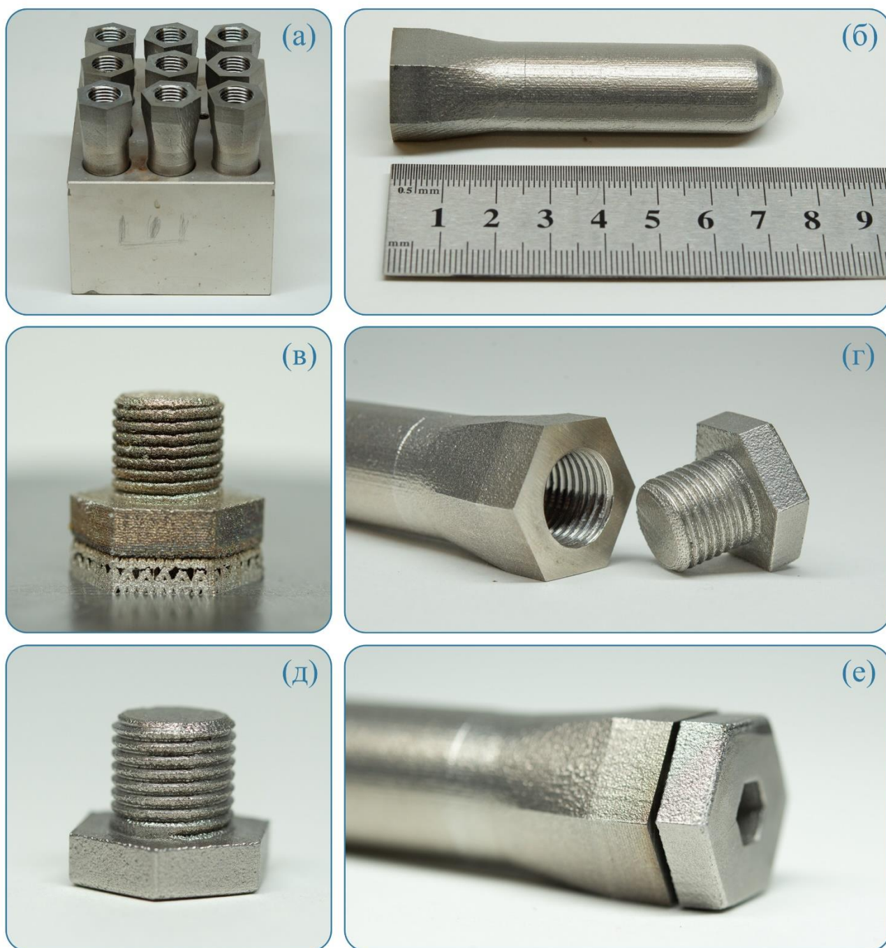
Рисунок 33. (а) SLM-реакторы, размещенные в стандартном химическом лабораторном термоблоке; (б) общий вид SLM-реактора без крышки; (в) крышка реактора на платформе 3D-принтера; (г) SLM-реактор с внутренней резьбой и крышка с внешней резьбой до сборки; (д) крышка после проведения постобработки; (е) собранная конструкция: крышка, полностью вкрученная во внутреннюю полость реактора, обеспечивающая герметичное соединение.
