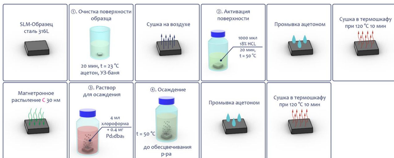
Рисунок 43. Осаждение наночастиц палладия на поверхность SLM-подложки из нержавеющей стали 316L: нанесение углеродного слоя толщиной 30 нм методом магнетронного распыления и последующая иммобилизация палладия путём термического разложения прекурсора \text{Pd}_2(\text{dba})_3 в хлороформе.
