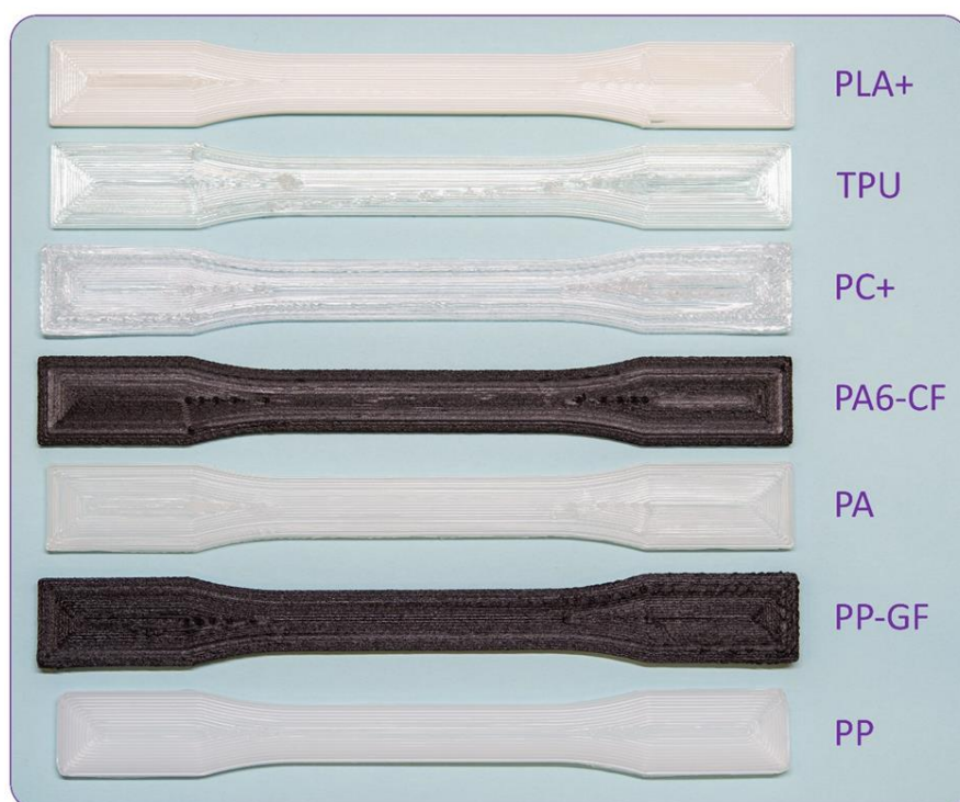
Рисунок 2. FFF-образцы для испытаний на растяжение с углом заполнения 0^\circ относительно направления приложения нагрузки.
