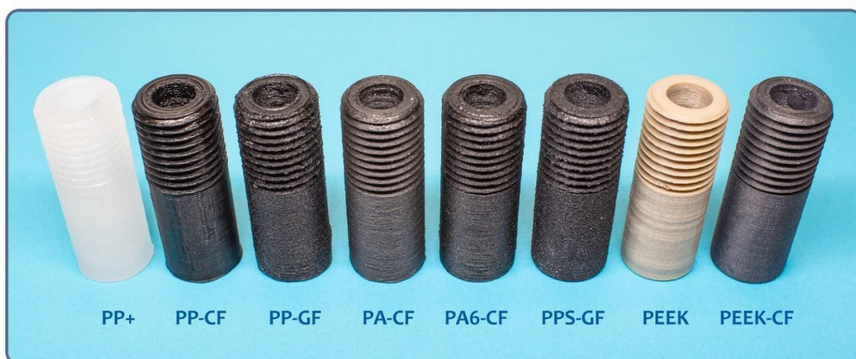
Рисунок 2. Изготовленные методом FFF герметичные реакторы, работающие в условиях избыточного внутреннего давления.
