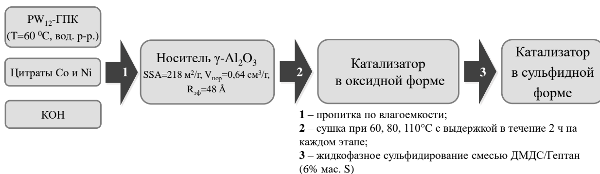
Рисунок 2.1 – Схема синтеза (\text{K})\text{Co}(\text{Ni})\text{W}/\text{Al}_2\text{O}_3 катализаторов.
