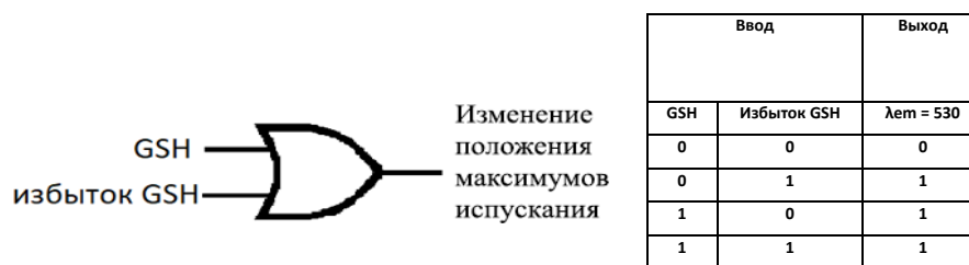
Рисунок 35. А) Схема синтеза соединения L34 . Б) Принципиальная схема механизма работы сенсора L34 . Двумя входными сигналами являются GSH и GSH. Выходной сигнал – изменение максимумов испускания. Как видно из таблицы истинности, мониторинг добавления GSH или избыток GSH ведет к молекулярному логическому элементу OR.
