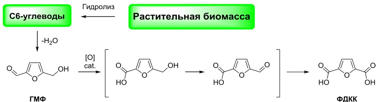
**Схема 2.** Общая схема получения 2,5-фурандикарбоновой кислоты из возобновляемой растительной биомассы.
