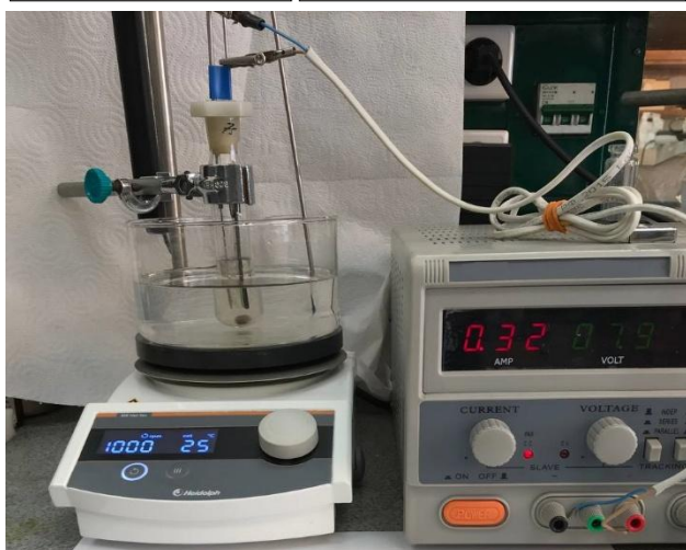
Рисунок 2. Неразделённая электрохимическая ячейка, оснащённая стеклоуглеродным анодом ( 4.5 \text{ см}^2 ) и платиновым катодом ( 4.5 \text{ см}^2 ) и подключённая к источнику постоянного тока. Электролиз смеси проводился при постоянном токе.
