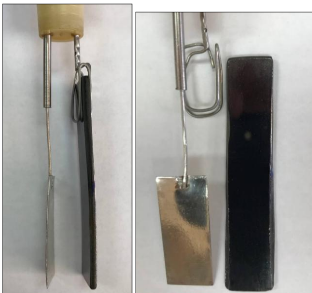
Рисунок 1. Стеклоуглеродный анод (рабочая поверхность - 4.5 \text{ см}^2 ) и платиновый катод (рабочая поверхность - 4.5 \text{ см}^2 ).
