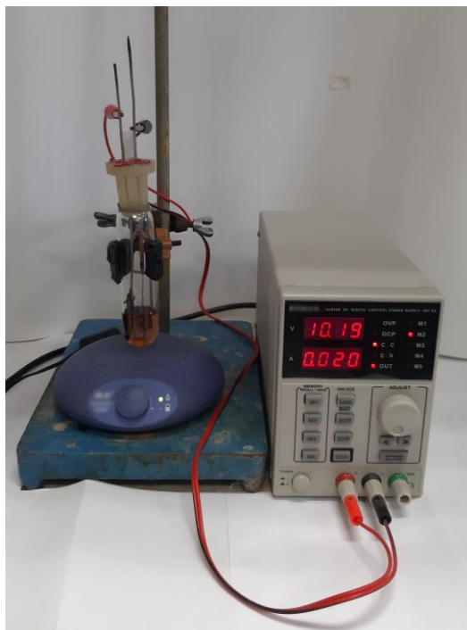
Рисунок 3 Электрохимическая установка во время электролиза
