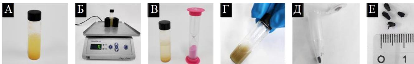
Рисунок 9. Процедура приготовления катализатора Pd/*P. yeii*: А – смесь ацетата палладия и суспензии клеток; Б – перемешивание смеси; В – перед продувкой водородом; Г – смесь после продувки H<sub>2</sub>; Д, Е – высушенный катализатор
