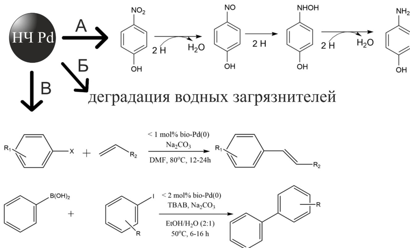
Рисунок 8. Применение биосинтезированных наночастиц Pd: А – гидрирование [249]; Б – деградация водных загрязнителей [251]; В – реакции кросс-сочетания [166]
