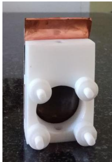
Рисунок 26. Конструкция электролизера из ПТФЭ с отверстием диаметром 24 мм. Стенка анода удалена для демонстрации катода из медной фольги, покрытого электроосажденными наночастицами германия
