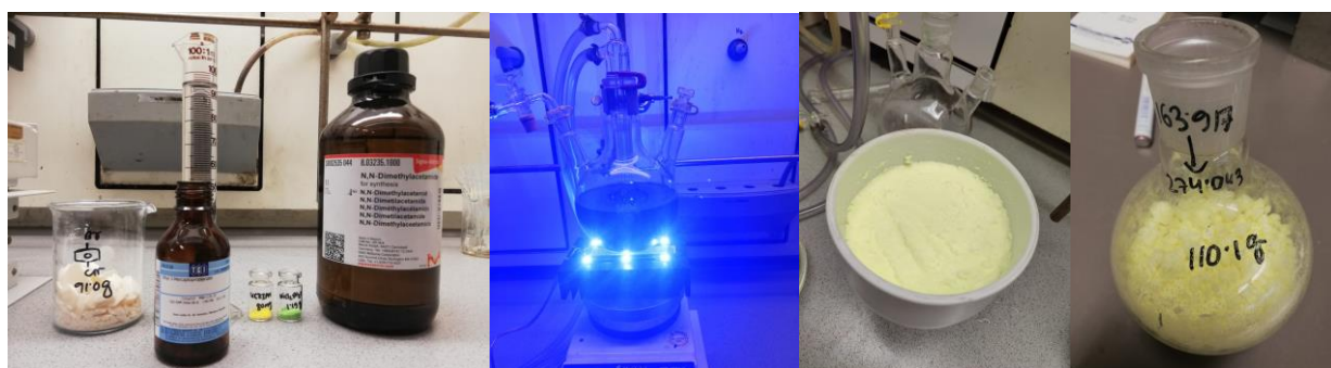
Рисунок 10. Схема масштабированного синтеза, проведённого в рамках МФРК кросс-сочетания тиолов и арилбромидов (сверху); изображения деталей синтеза (снизу) слева направо: реагенты, фотохимическая установка, отфильтрованный на воронке Бюхнера продукт, отсушенный продукт
