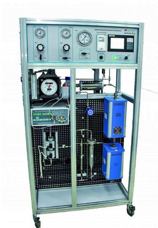
Рисунок 6. – Каталитическая проточно-циркуляционная установки синтеза Фишера-Тропша.
