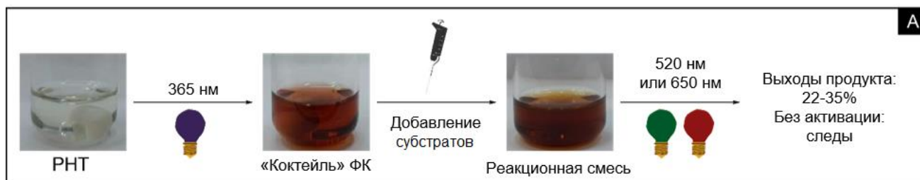
Рисунок 57. Эксперимент по активации фенотиазина УФ светом проведение модельной реакции с участием облученного фенотиазина, т.е. «коктейля» фотокатализаторов.
