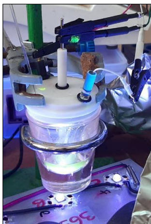
Рисунок 36. Фотография электрохимической установки для проведения экспериментов при УФ (365 нм) облучении.
