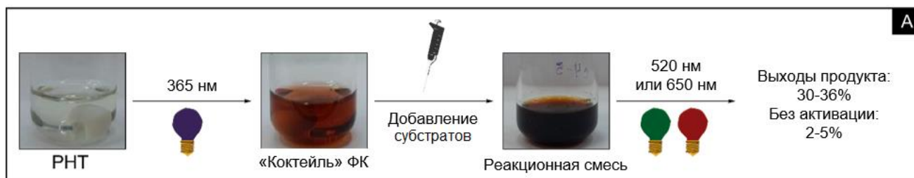
Рисунок 58. Эксперимент по активации фенотиазина УФ светом проведение модельной реакции с участием облученного фенотиазина, т.е. «коктейля» фотокатализаторов.
