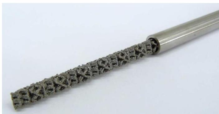
**Рисунок 4.** Каталитический статический смеситель, покрытый Ni(0) и Pt(0).
