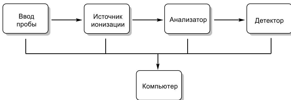
Рисунок 28. Принципиальная схема масс-спектрометра.
