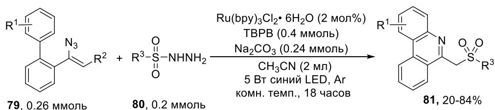
Схема 29. Ru-катализируемая фотохимическая реакция винилазидов 79 и сульфонил гидразинов 80 с образованием фенантридинов 81
