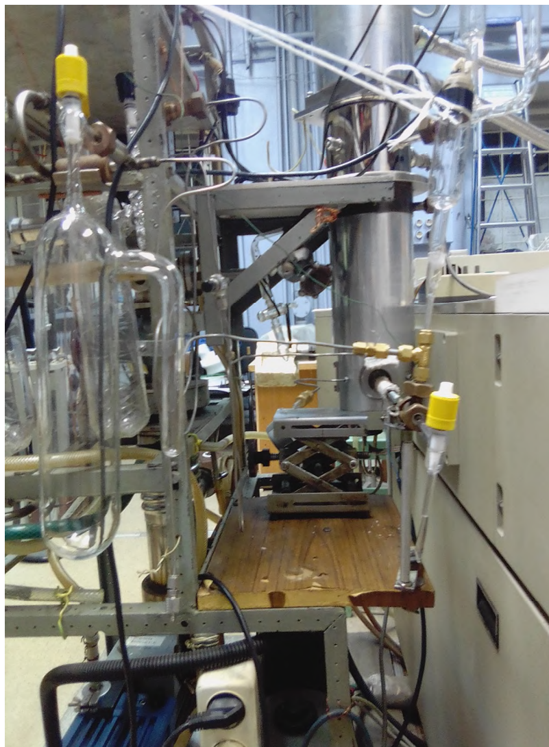
Рисунок 21. Установка для матричной изоляции. На переднем плане видны колба для подготовки газовой смеси, держатель с предшественником \text{SiCl}_2 и пиролизер. На заднем - форвакуумный и диффузионный насосы и криостат, справа – ИК-спектрометр.
