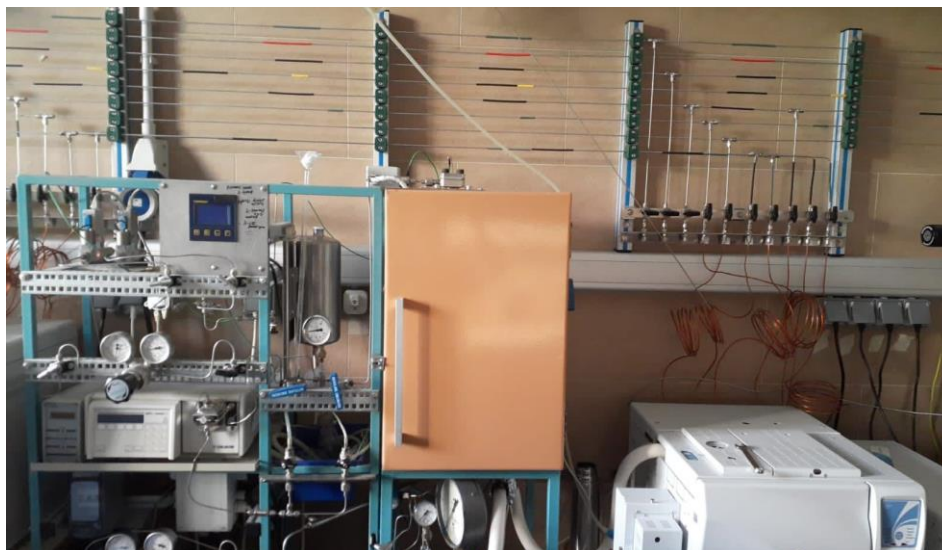
Рисунок 2.2 - Проточная установка для реакции гидрирования.
