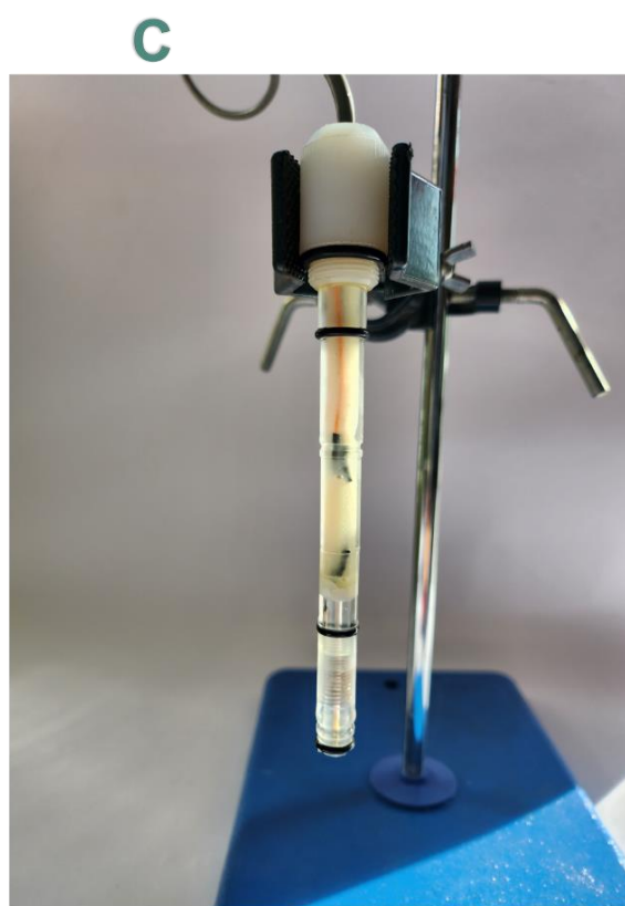
Рисунок 2. (A) Схематическое изображение биогибридного материала, масштаб выбран произвольно для удобства визуализации; (B) биосенсор; (C) кислородный электрод с гибридными биокатализаторами на основе ассоциации дрожжевых клеток, иммобилизованных в золь-гель матрице.
