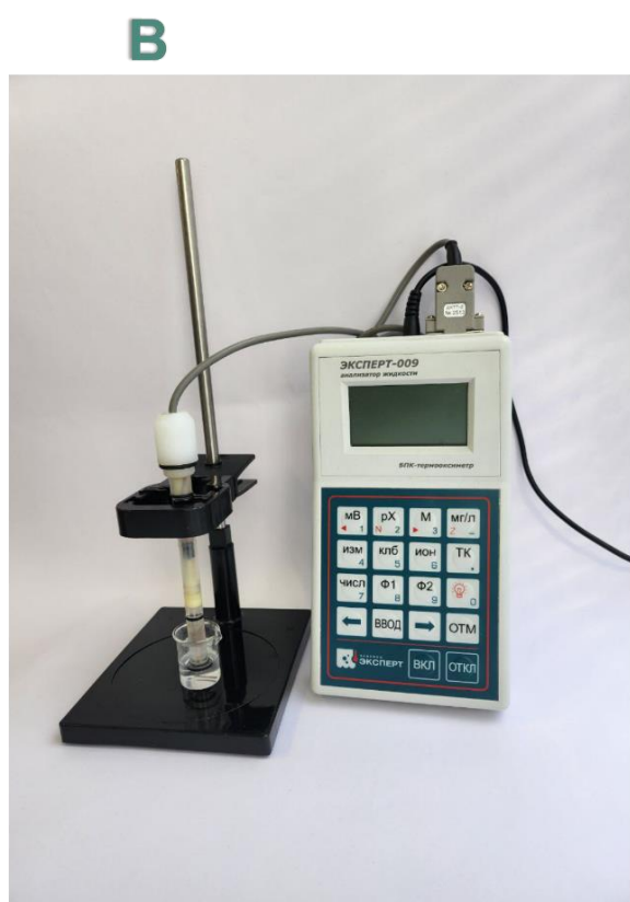
Рисунок 2. (A) Схематическое изображение биогибридного материала, масштаб выбран произвольно для удобства визуализации; (B) биосенсор; (C) кислородный электрод с гибридными биокатализаторами на основе ассоциации дрожжевых клеток, иммобилизованных в золь-гель матрице.
