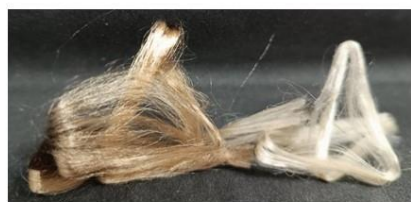
Волокна, сформованные из растворов целлюлозы, полученных разными способами из мискантуса
