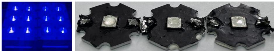
Рис. 1. Слева – различия в фотореакторах (блок, расположенный правее, более старый), справа – наблюдаемое разрушение линз светодиодов с течением времени.
