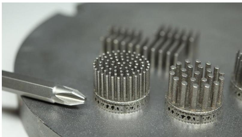
Рис. 1. Тестовые компоненты химических реакторов, изготовленные методом SLM из нержавеющей стали.
